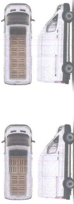
L2H3 Furgão com capacidade volumétrica de carga de 10,7m³ e categoria "B" de habilitação.
