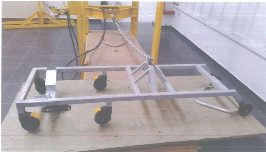
Foto 07-Aplicação de carga no sentido lateral
