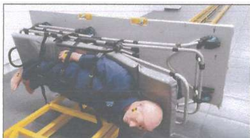
Figura 15 – Impacto vertical (depois do teste)
