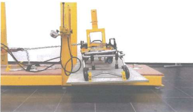
Figura 13 – Ensaio de tração lateral
