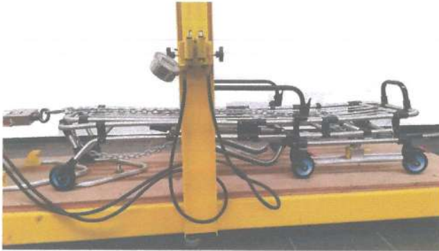
Figura 11 – Ensaio de tração frontal
