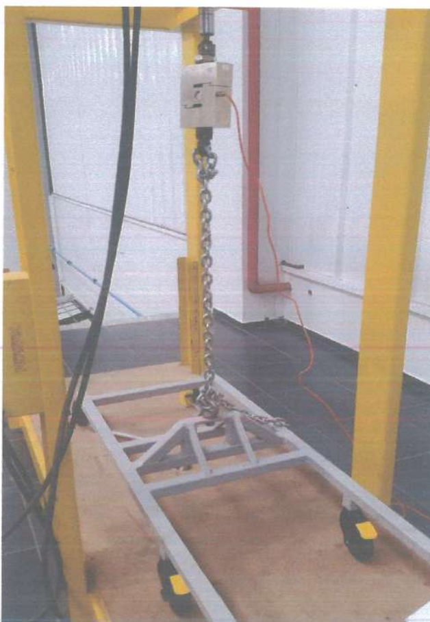
Foto 06 - Aplicação de carga no sentido vertical
