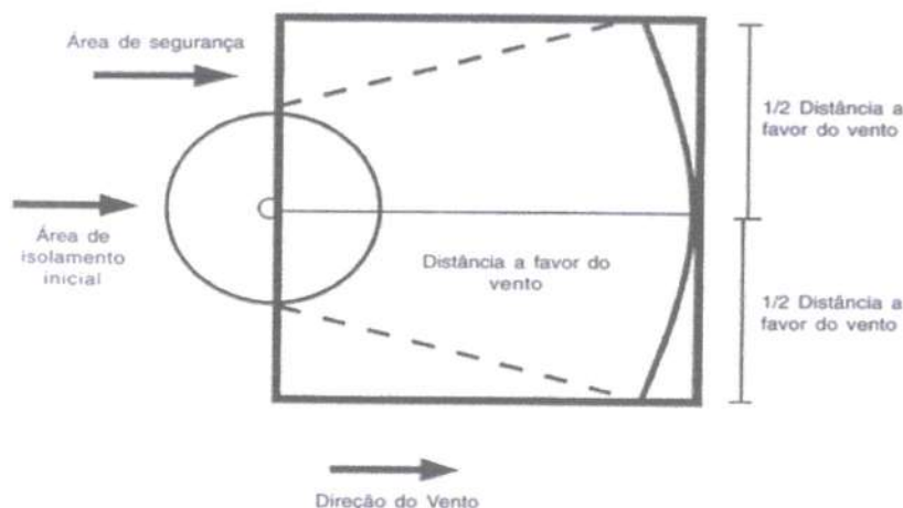
Figura 1 – Isolamento da área
