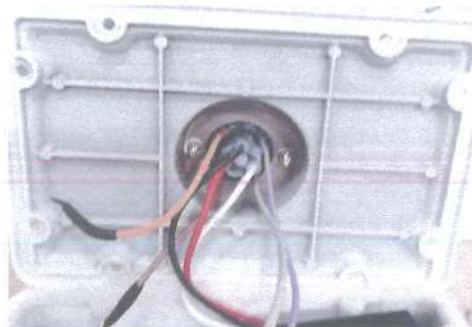
IP6X - Evidência de NÃO ingresso de poeira no alojamento do controlador da luminária
