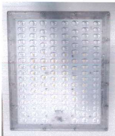
IPX6 - Evidência de NÃO ingresso de água no compartimento óptico da luminária
