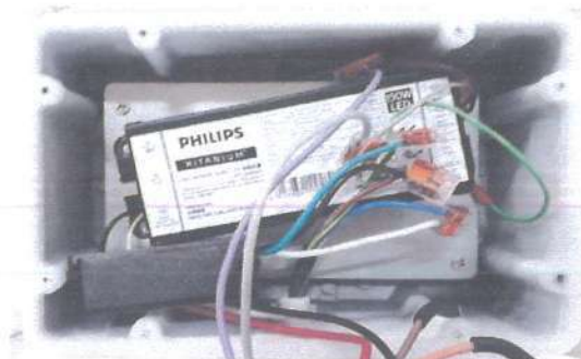
IP6X - Evidência de NÃO ingresso de poeira no alojamento do controlador da luminária
