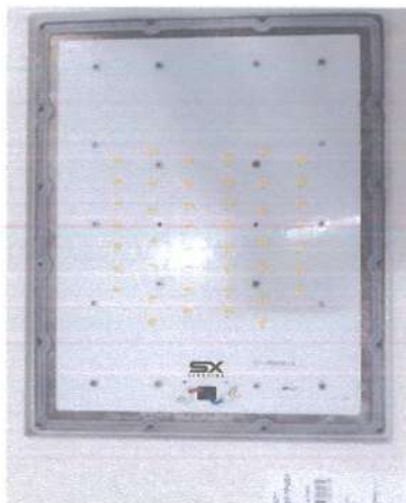
IP6X - Evidência de NÃO ingresso de poeira no compartimento óptico da luminária
