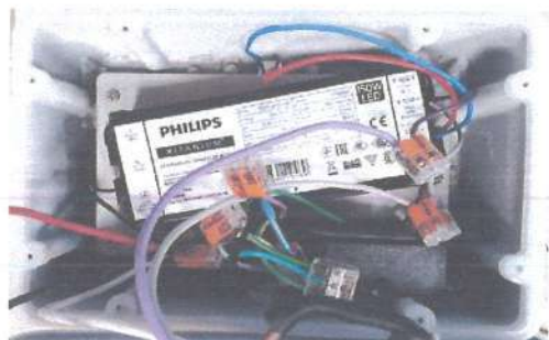
IPX6 - Evidência de NÃO ingresso de água no alojamento do controlador da luminária
