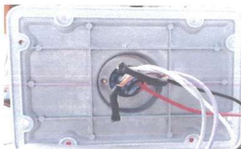
IPX6 - Evidência de NÃO ingresso de água no alojamento do controlador da luminária
