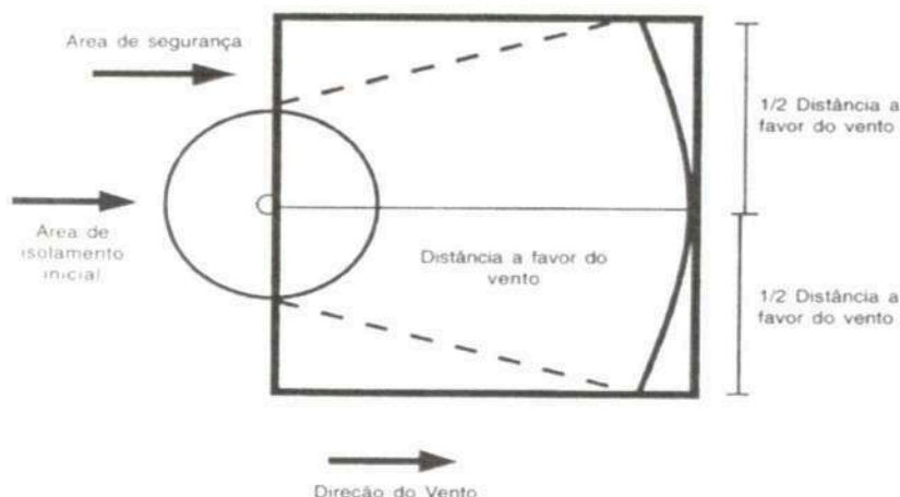
Figura 1 – Isolamento da área
