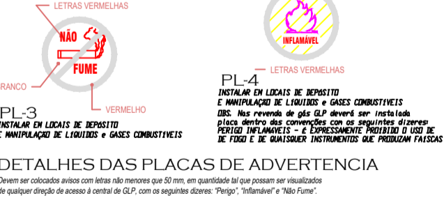
DETALHES DAS PLACAS DE ADVERTÊNCIA
