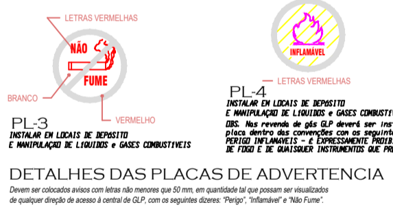
DETALHES DAS PLACAS DE ADVERTÊNCIA
