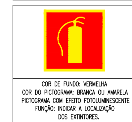
SINALIZAÇÃO DE EXTINTORES
